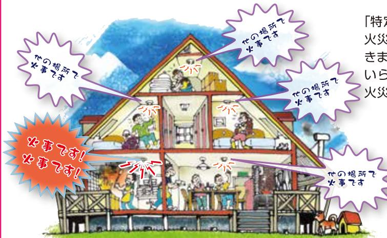
「特定小規模施設用自動火災報知設備」が設置できます（配線と受信盤のいらない無線式の自動火災報知設備など）。
