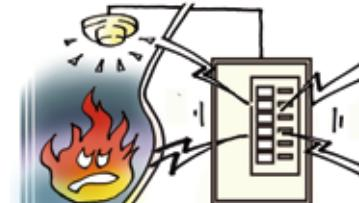
自動火災報知設備は、部屋等に設けて火災を感じる「感知器」とその感知器からの信号を受信して、警報を発する受信機等により構成されています。
